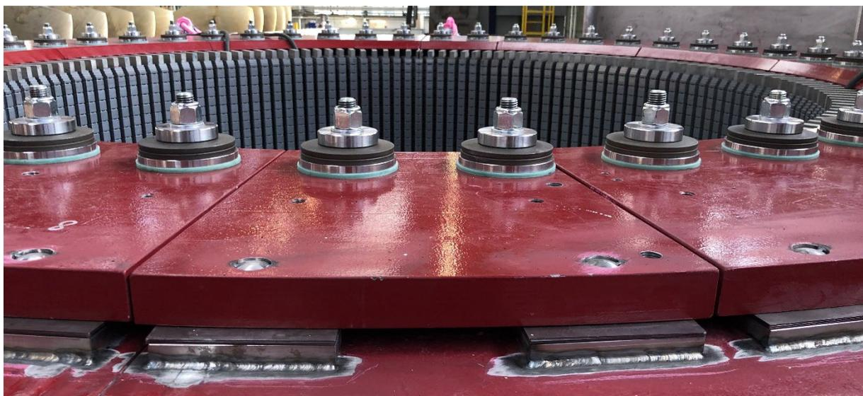
Abbildung 2-2: Blechpaket mit Mittelspannbolzen und Tellerfedern
