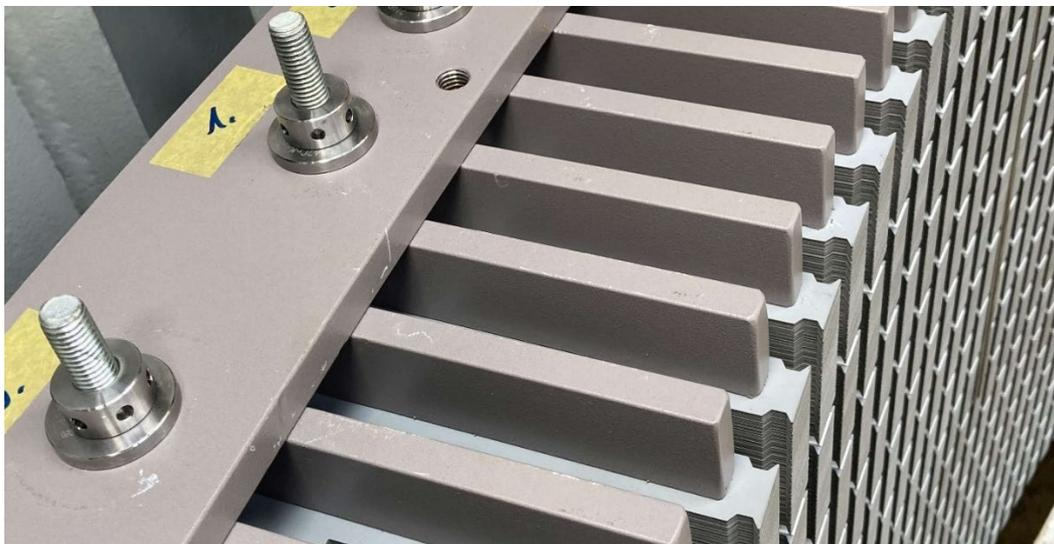
Abbildung 1-1: Blechpaket mit Mittelspannbolzen
