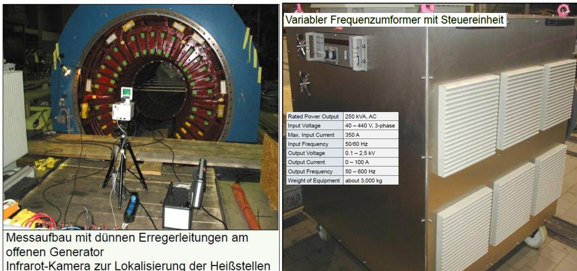
Abbildung 5-4: Magnetisierungsprüfung mit einer mobilen elektronischen 500-Hz-Anlage während einer Großrevision in einem Kraftwerk
