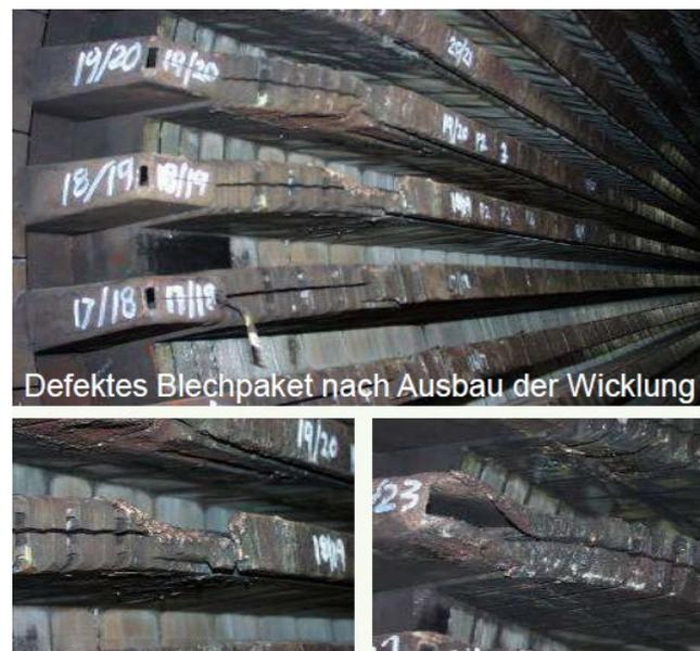
Abbildung 1-1: zeigt einen typischen Blechpaketschaden an einem Generator mit Blechpaketbrand und Zahnschmelze.
