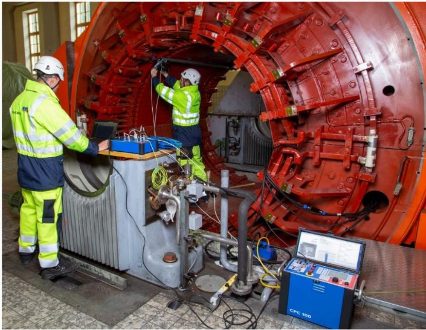
Abbildung 5-9: Prüfaufbau im Kraftwerk. Die Erregerwicklung befindet sich rechts
