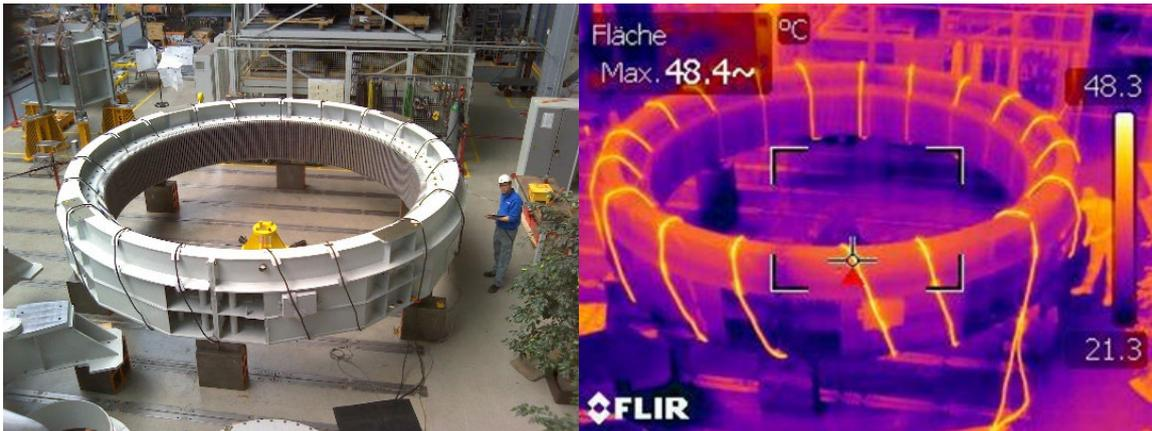
Abbildung 5-1: Magnetisierungsprüfung an einem kurzen unbewickelten Blechpaket;
