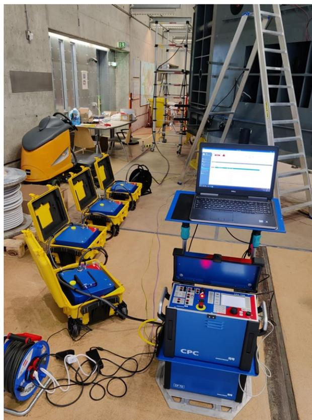
Abbildung 3-6: Beispiel eines schlüsselfertigen digitalen Messsystems. Die Kontrolleinheit und der Inverter sind unterhalb des Laptops. Noch einmal darunter befinden sich der Transformator, sowie die digitale Messwerterfassung zusammen mit dem Referenzkondensator. Die Kompensationsdrosseln (in diesem Fall 4 Stück, abhängig von der Wicklungskapazität) befinden sich aufgereiht in der linken Bildhälfte.
