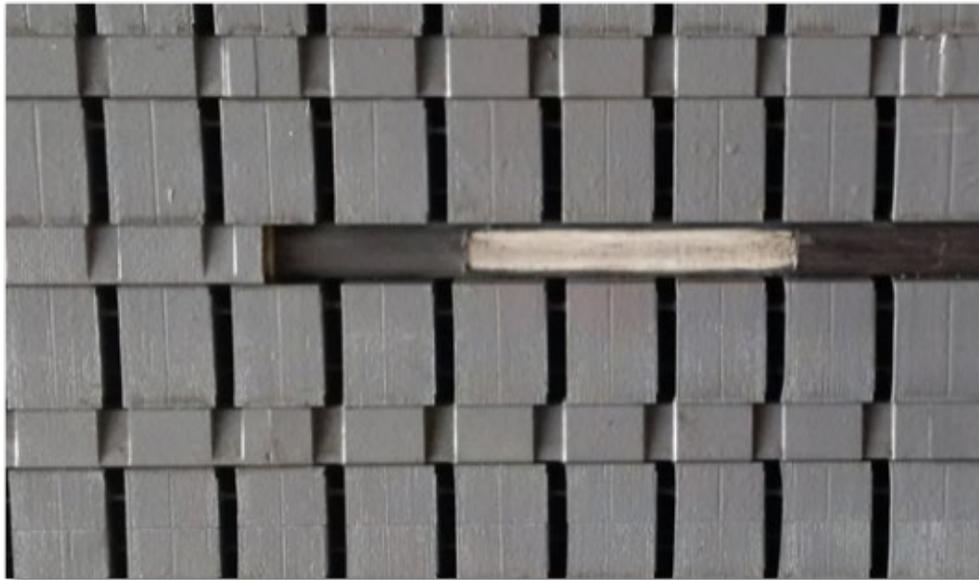
Abbildung 4-5: Simulierter Schaden am Außenglimmschutz AGS – Nutentladungen (slot discharges), Nutverschlusskeil zur besseren Erkennbarkeit entfernt
